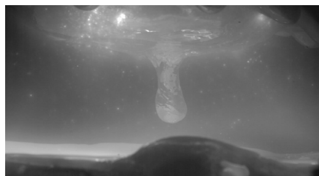
Fig. 2 - Vue du plasma d'arc en cours de fusion observé à l'aide d'une caméra rapide.
